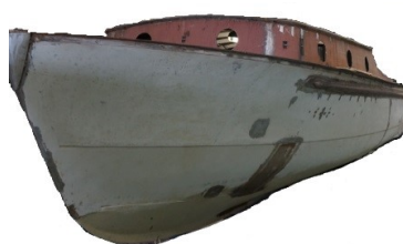
Teer Epoxy kan direct op blank staal. Mits deze stof en vetvrij is.
